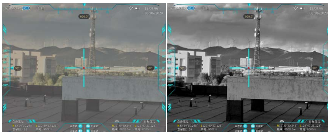
图 30 可见光透雾效果（左：透雾关闭，右：透雾打开）
